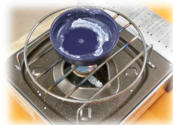
蒸発皿に広がった液体の端から蒸発が始まり、液体によって白い個体が出出てきます。
